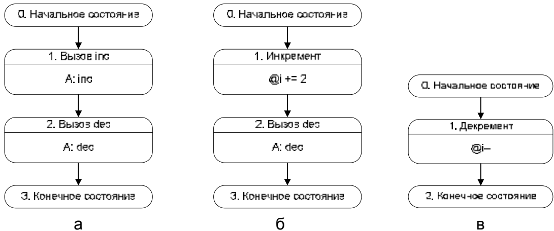
Рис. 36. Прямые автоматы для процедур main (а), inc (б) и dec (в)
